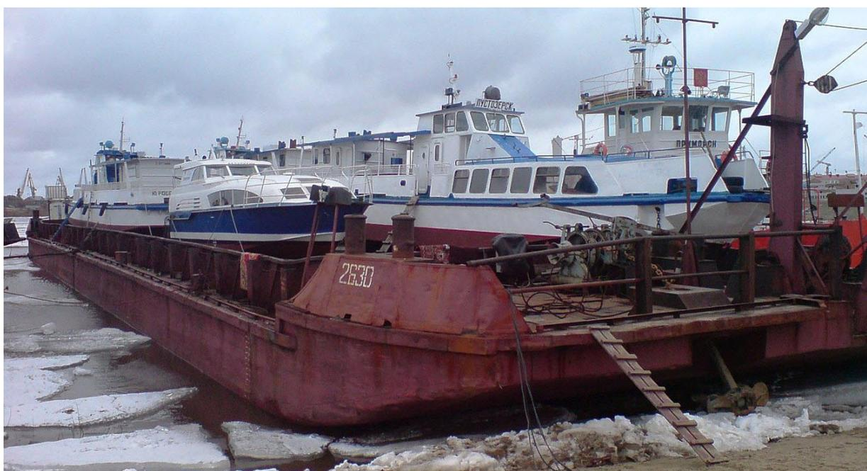
Рис. 2. Бункерная баржа «ББР-2630» проекта Р-89
